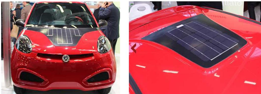
Fig. 6.6 – Foto della i.Car0. particolare anteriore e del tetto munito di pannelli fotovoltaici.
