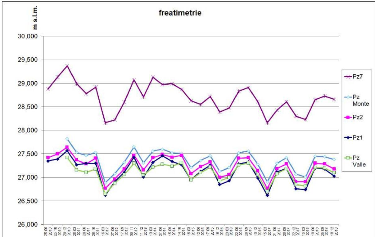
**Figura 5 - Quote rilevate nei piezometri superficiali in m s.l.m.**
